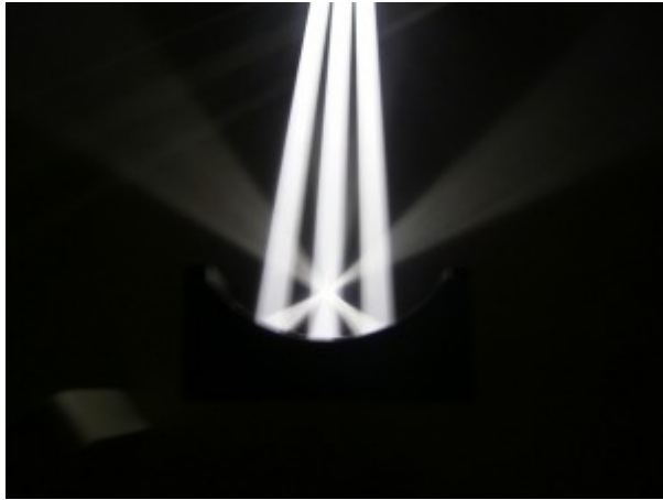
Image: "Strahlengang in einen Hohlspiegel" by Johannes S. License: CC BY-SA 3.0
